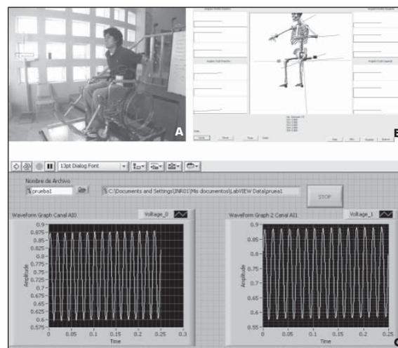
Figura 1. Quiñones I, et al. En la Figura 1A se muestra como se colocaron los sensores. 1B muestra la herramienta programada para desplegar el modelo biomecánico. 1C muestra el programa desarrollado para comprobar el modelo
