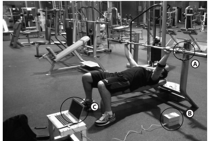
Figura 2. A. Enganche de unión entre la barra y el transductor lineal; B. transductor lineal; C. portátil.
