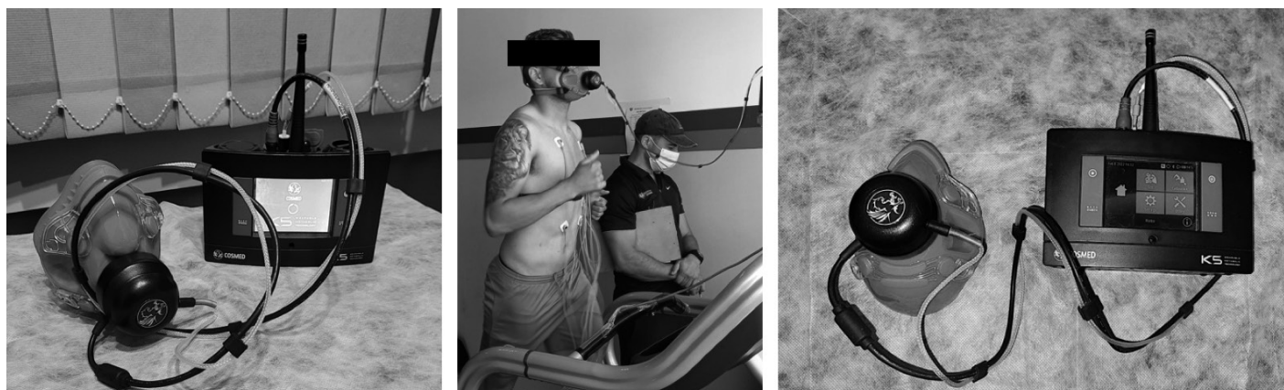
Figura 1. Analizador de gases portátil utilizado en el estudio.
